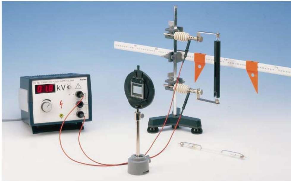
รูปที่ 3 ชุดอุปกรณ์การทดลอง Balmer Series
